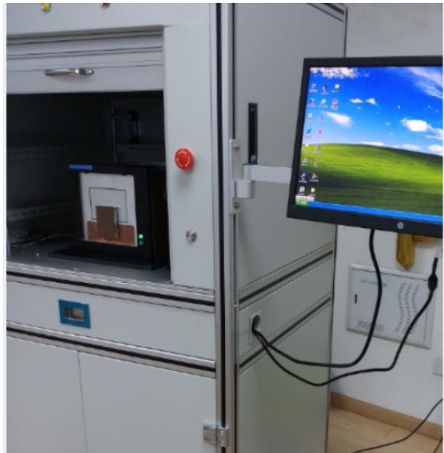
全球对电动汽车电池性能测试需求日益增大。汽车电池必须经过恶劣条件下性能新能源三电测试，以确保其承受运输和日常使用安全。恶劣环境包括在极限温度使用，运输或行驶过程中反复冲击和振动。电池测试包括电气、振动和环境测试。同时完成这些测试可以更好地模拟电动汽车日常运行环境，以确保驾驶员的安全。如：温湿度电池性能，汽车急加减速、急刹车或车辆碰撞引起的电池撞击电池托架而导致电池变形，汽车行驶或运输过程中经常处于颠簸状态，电池内部的极板、隔板、电解液等，在不断振动的情况下可能发生变形、脱落、疲劳断裂或泄露等。
