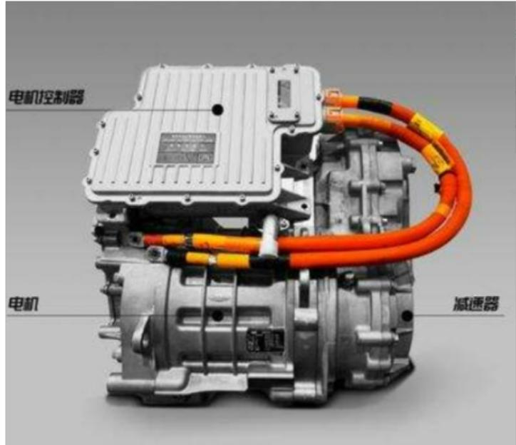
新能源汽车中的大三电和小三电，纯电动车中的大三电一般指的是动力系统部分的控制器。纯电动车的动力来源于动力电池，动力电池为化学电源，向高压动力回路提供电能，一般是由许多个单体电芯先并联后串联组成，并由电池管理系统BMS进行控制，以保证动力电池的安全性及稳定性，目前应用较较多的是磷酸铁锂电池和三元锂电池。驱动电机是将动力电池的电能转化为机械能的装置。目前较多应用的永磁同步电机和交流异步电机。电机控制器将动力电池提供的高压直流电转化为三相交流电，在整车控制策略下根据驾驶员的意图控制驱动电机的电压和电流，完成电机驱动扭矩、旋转方向及速度的控制。电池充电系统的新能源三电测试，电池充电系统是将外界的充电桩、充电站等充电装置中的交流电转换为直流电。宁波新能源电机整机测试哪家好
